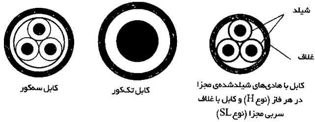
شکل ۲-۷۳ کابل‌های قدرت معمول مورد استفاده در شبکه
