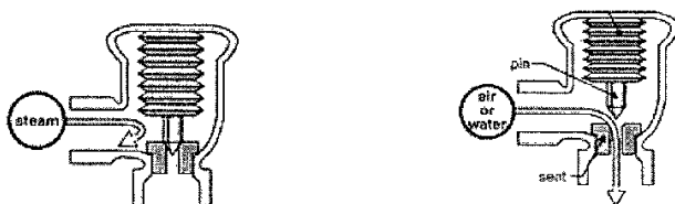
شکل ۱۳-۷۷: عملکرد تله بخار ترموستاتیک
