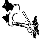
شکل ۴-۲: انتقال حرارت توسط هدایت از انتهای فاشی به دسته آن
