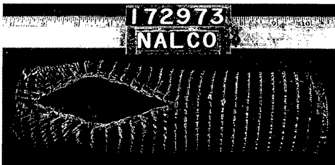
شکل ۹.۵. شکست بزرگ در لوله سوپرهیتر یک بویلر سیکل ترکیبی. این لوله پس از شکست لوله‌های نزدیک آن، یک دوره بیش‌گرمایش بلندمدت را پشت سر گذاشته و سپس دچار بیش‌گرمایش کوتاه‌مدت شده است.
