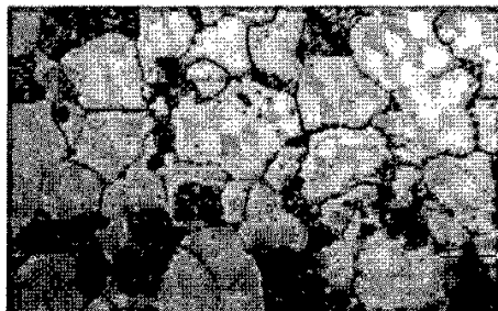
شکل ۲۵.۱۶. ساختار متالورژیکی میانه ضخامت لوله سمت شعله
